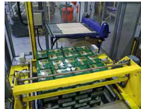
Een snellere palletiser, geleverd door Idépack, kan maximaal zes lagen per minuut palletiseren; een verdubbeling van de capaciteit
