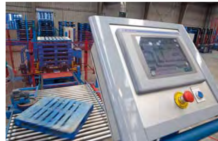
Binnenkomende pallets worden volautomatisch de fabriekshal ingeleid
