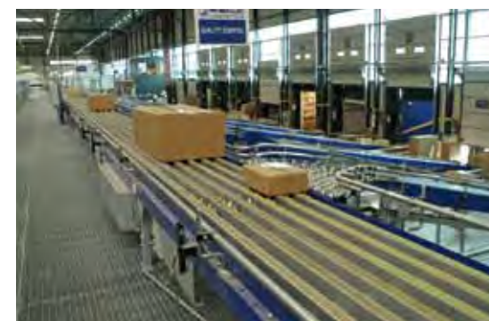
Op basis van de unieke code op het shippinglabel worden de orders uitgesluisd. Elke baan representeert een andere vervoerder
