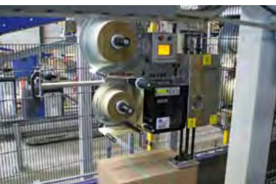
Met hoge snelheid en zonder stop worden de dozen voorzien van de benodigde etiketten
