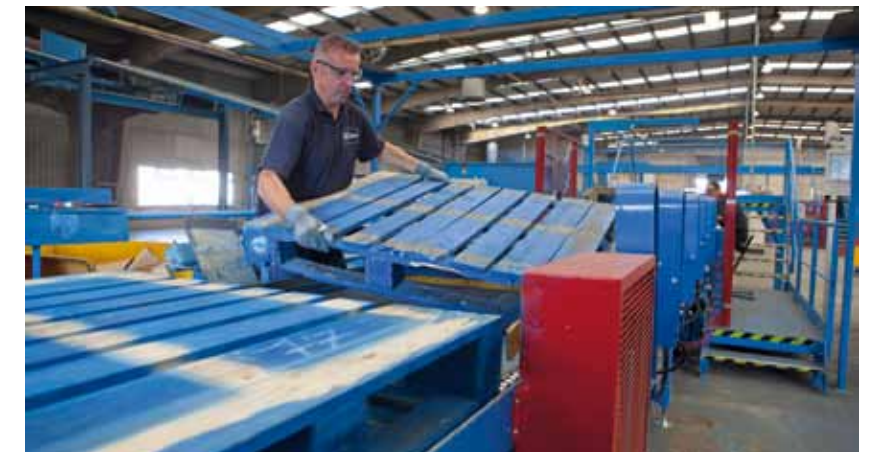
Na binnenkomst in het service center worden de pallets geïnspecteerd. Pallets die in goede staat verkeren, worden meteen opnieuw gespoten
